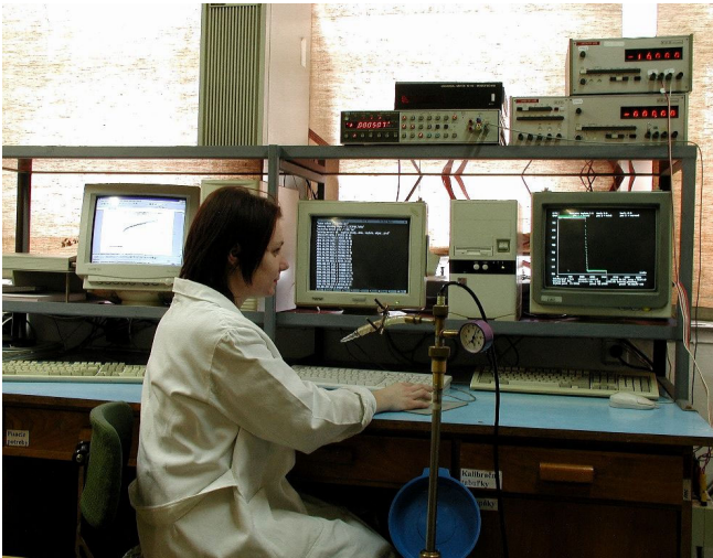
Meranie kritickej teploty vysokoteplotných supravodičov transportnou metódou. (M. Majerová)
