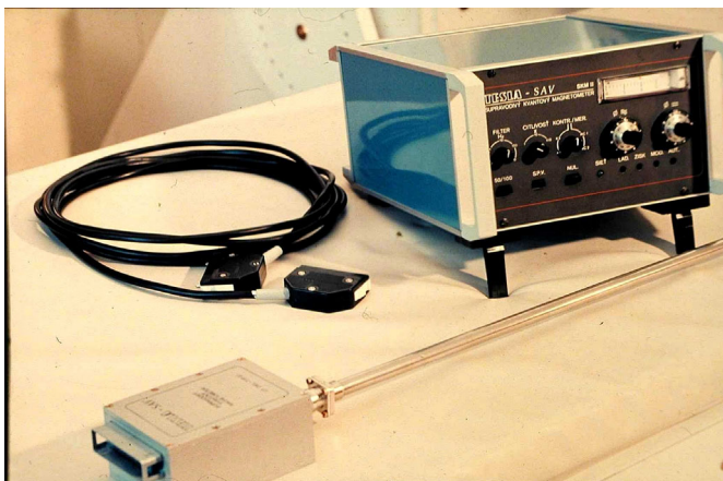
Supravodivý kvantový magnetometer vyrobený na ÚM SAV (v spolupráci s bývalým š.p. TESLA).
