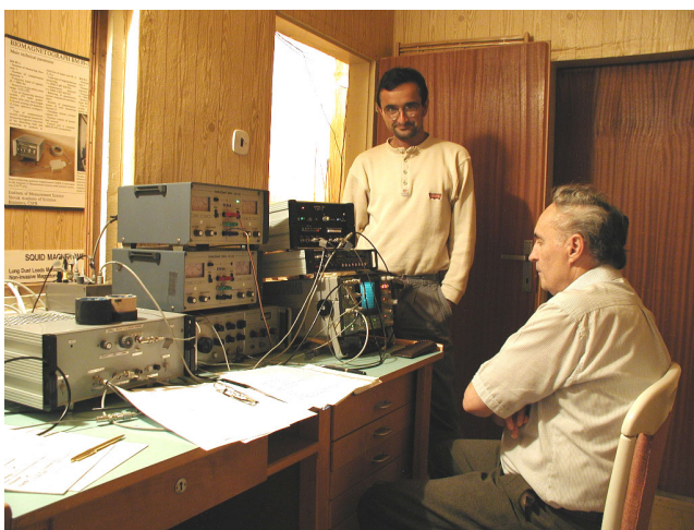
Meranie magnetizačných charakteristík vysokoteplotných supravodičov - riadiaca a vyhodnocovacia časť aparatury. (V. Zrubec a J. Maňka)
