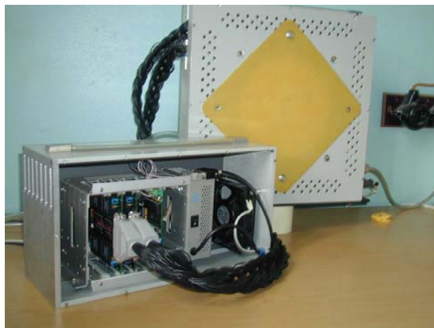
Elektronika a proporcionálna komora merača priestorových parametrov zväzkov jadrových častíc pre urýchľovač Nuklotrón
