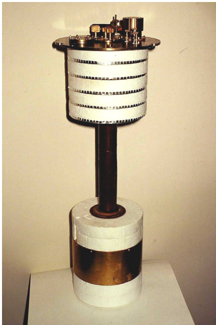
Pohľad na kryogénny modul zariadenia na meranie intenzity a polohy zväzkov nabitých častíc urýchľovaných v supravodivom urýchľovači NUKLOTRÓN (spolupráca so SÚJV Dubna).
