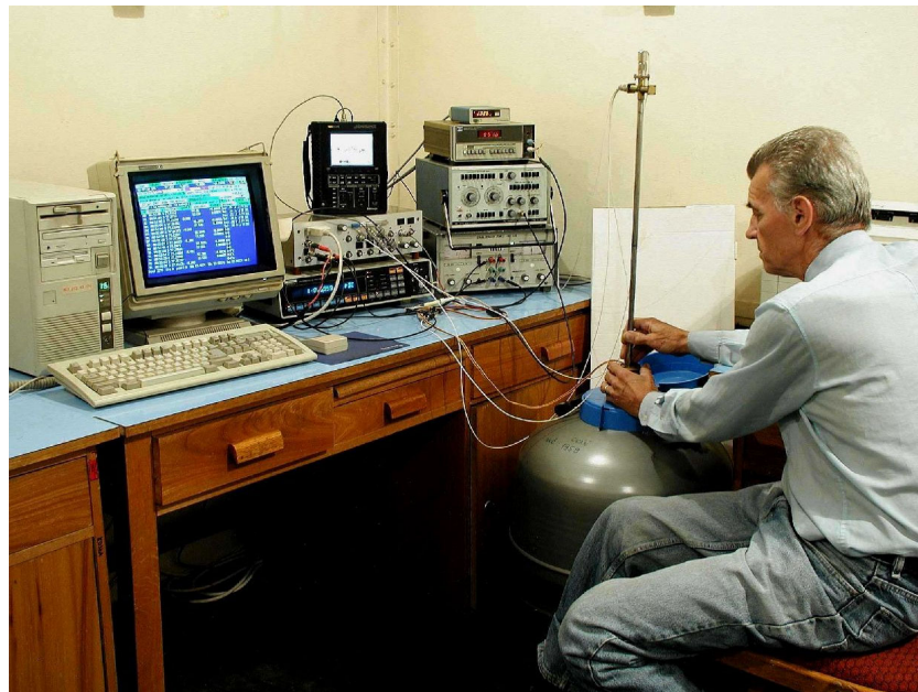
Meranie prechodových charakteristík vysokoteplotných supravodičov indukčnou metódou. (A. Koňakovský)
