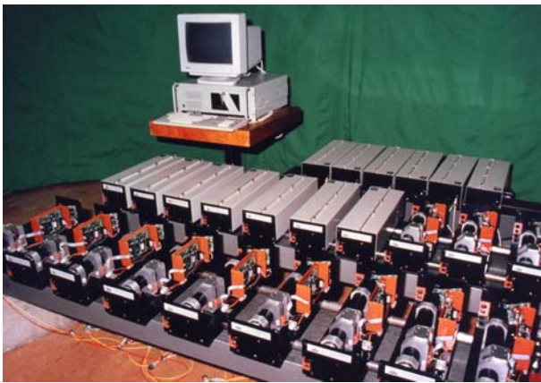
Merací systém HOLMES s 25 hydrostatickými snímačmi
